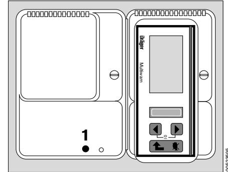
Si se carga únicamente la unidad de alimentación, está encendido durante la carga un LED rojo en la unidad de alimentación.
