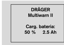
El proceso de carga completo de una batería vacía dura como mínimo unas 9 horas.
